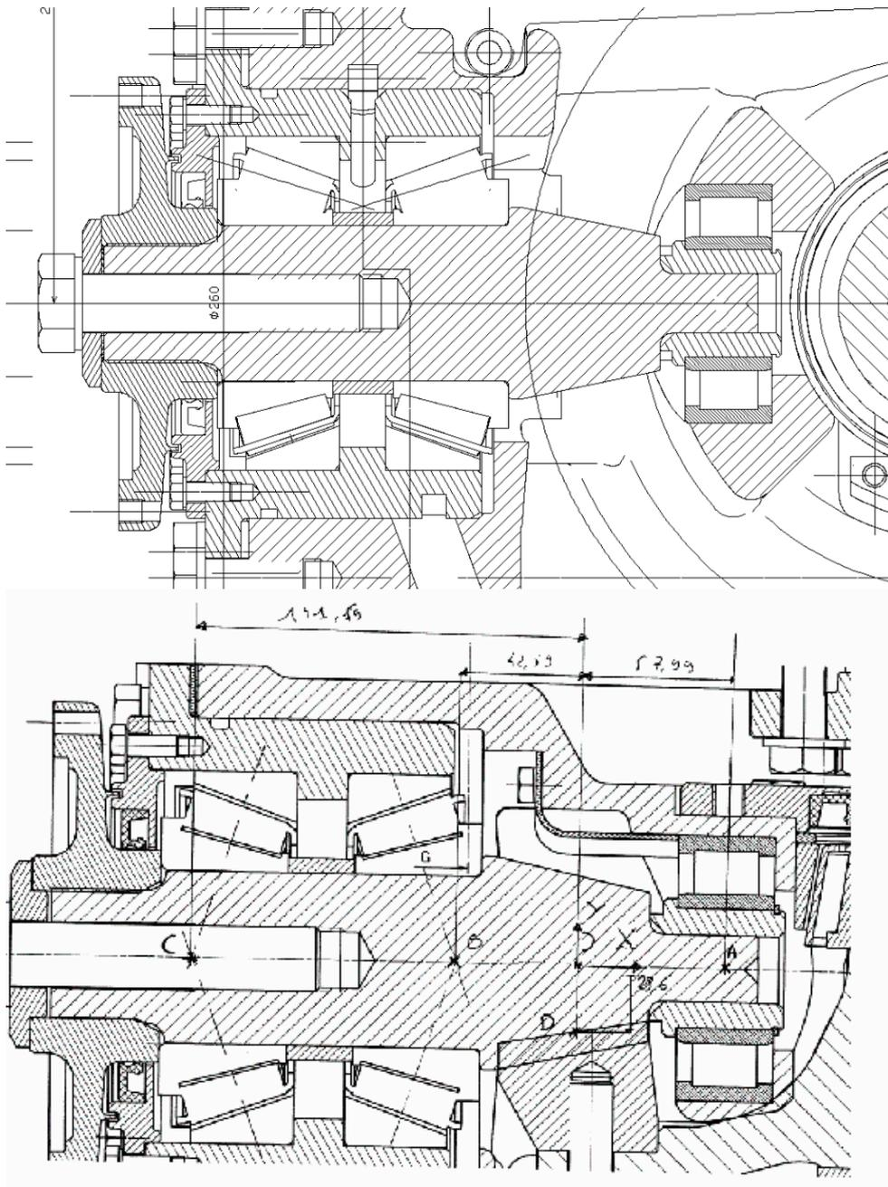
Le guidage de l'arbre peut être modélisé à l'aide de deux rotules et une sphère cylindre :
